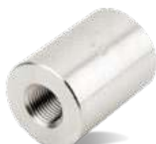
Cupla de reducción roscada De Ø1/8" a Ø2" NPT / BSPT
