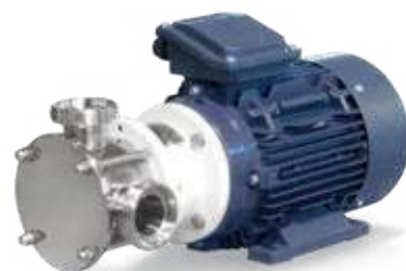
Bomba rodete flexible RF Caudal máx. 28 m³/h. Altura máx. 4 BAR.
